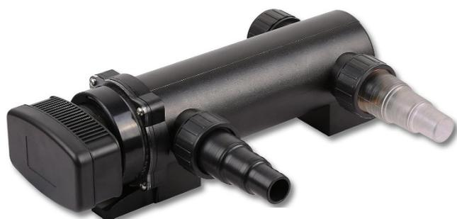
A linha CUV é usada para clarear a água de tanques e lagos através da eliminação de algas em suspensão. Possui também um tubo de quartzo para otimização de funcionamento e proteção da lâmpada UV-C. Adequado para uso em água doce ou salgada.
