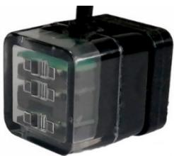
WAVEREEF NATO 3M é a última geração de sensores de níveis ópticos ATO (Auto Top Off). Com inéditos Três sensores ópticos, NATO 3M preserva a vida útil da bomba de reposição ao permitir maior variação de nível (5mm) – ligando/ desligando menos vezes a bomba ao dia. Além do ganho em confiabilidade no sistema, por preservar a bomba, conta ainda com o terceiro sensor para garantir o desligamento do sistema em caso de falha no segundo sensor. Inclui bomba.
